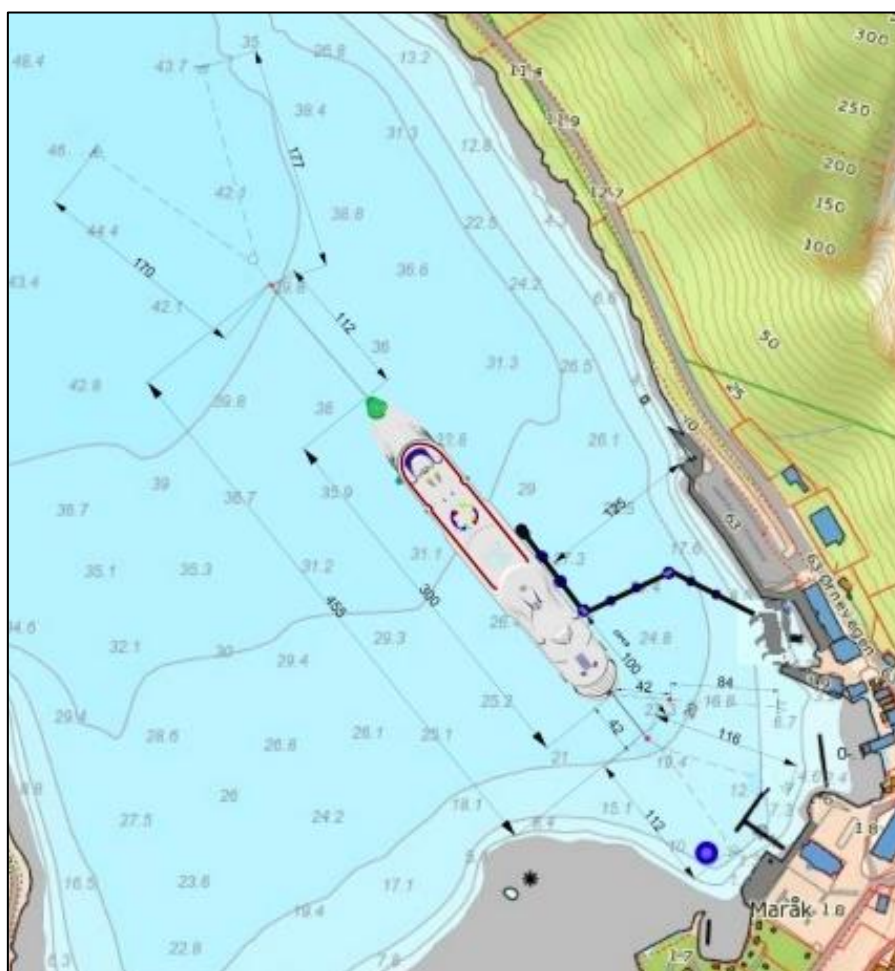
Slika 18: Nacrt sustava priveza sa mobilnim pontonskim gatom SeaWalk u luci Geiranger, Norveška (1)
